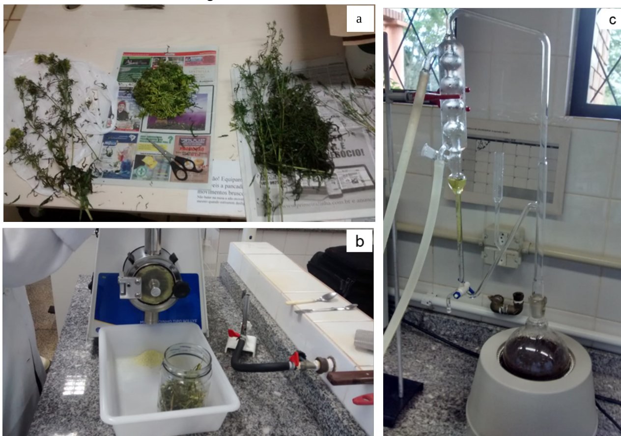
Figura 8. Obtención de aceites esenciales
