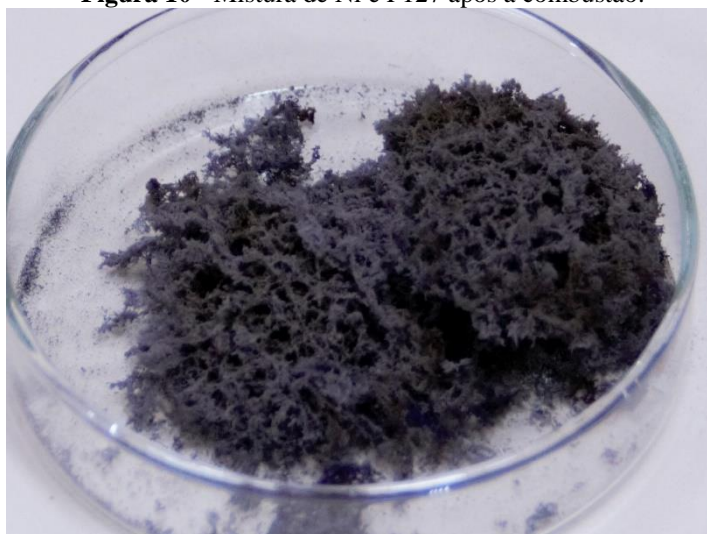
Figura 10 - Mistura de Ni e F127 após a combustão.
