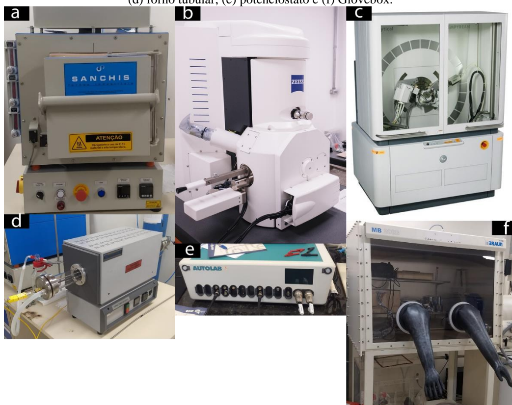
Figura 6 - Equipamentos utilizados: (a) forno mufla, (b) microscópio eletrônico de varredura, (c) difratômetro, (d) forno tubular, (e) potenciostato e (f) Glovebox.
