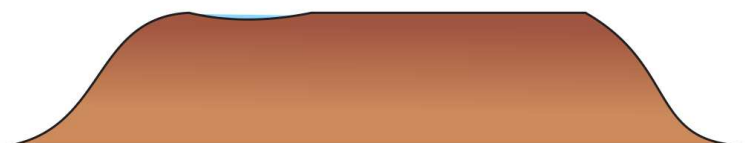
Figura 3.7 Seção transversal imprópria com nível de severidade baixa.
