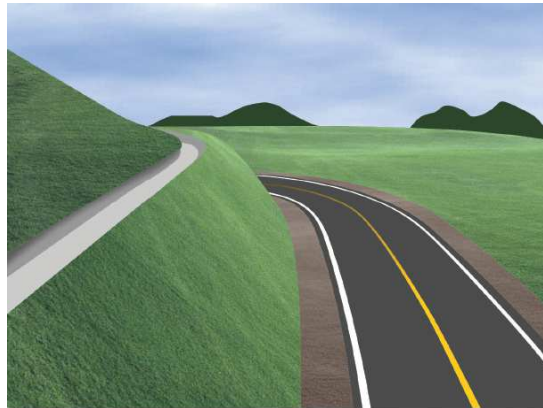
Figura 3.3 Valeta com revestimento
