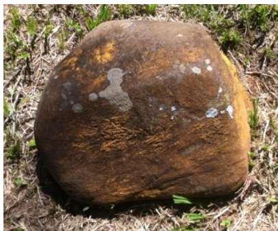
Figura 3.5. Biodeterioração de uma rocha.
