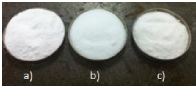
Figura 3.7. Componentes do CFM. a) Óxido de magnésio b) Fosfato c) Bórax.
