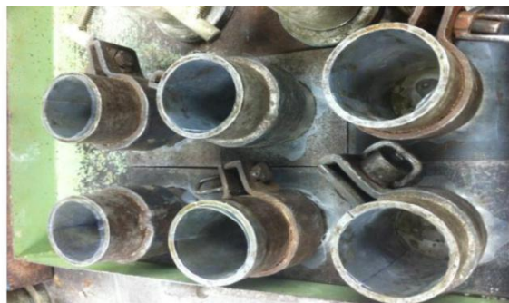
Figura 4.9. Moldes convencionais protegidos.
