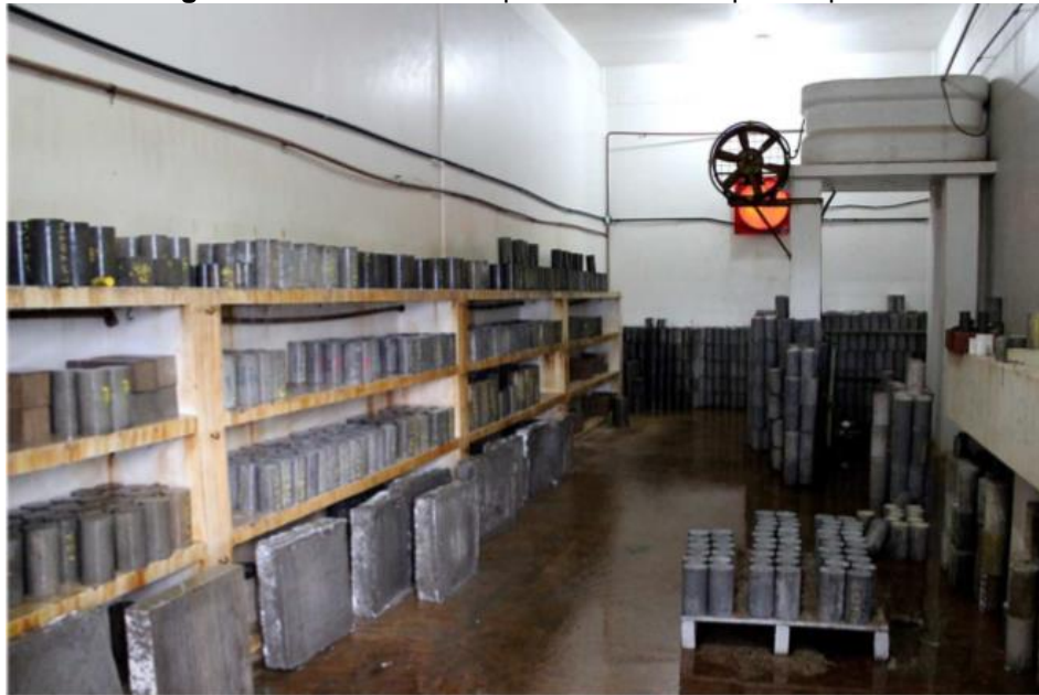
Figura 24. Câmara úmida para cura dos corpos de prova
