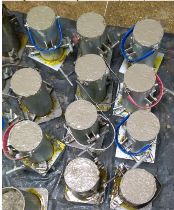
Figura 22. Moldagem dos corpos de prova
