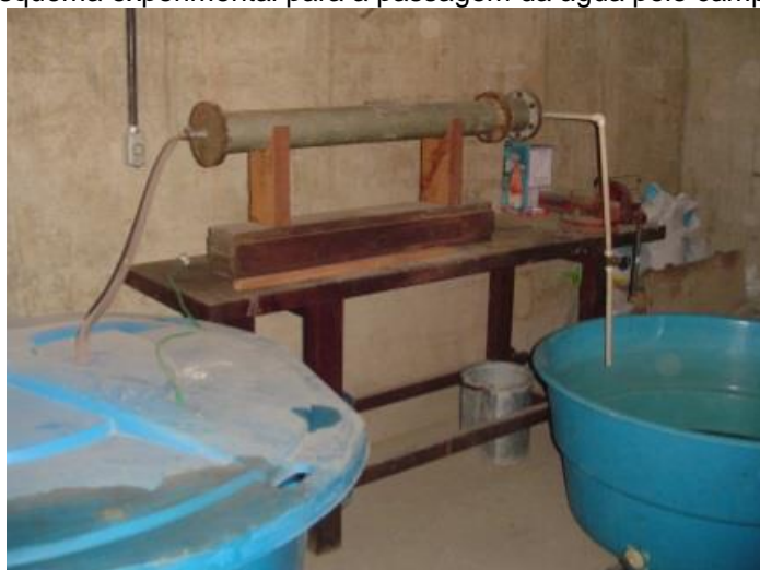
Figura 5. Esquema experimental para a passagem da água pelo campo magnético
