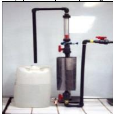
Figura 7. Equipamento para a passagem de água
