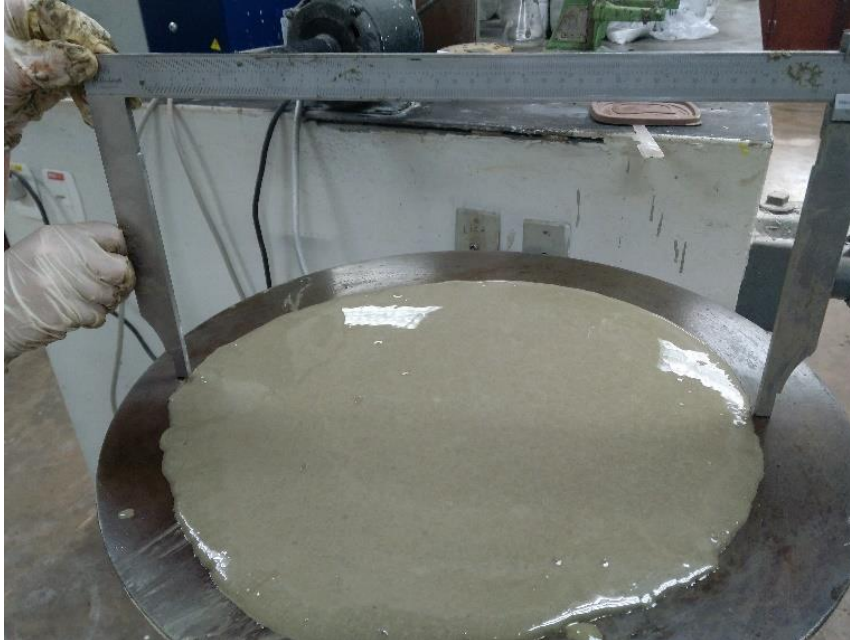
Figura 19. Ensaio de determinação do índice de consistência da argamassa
