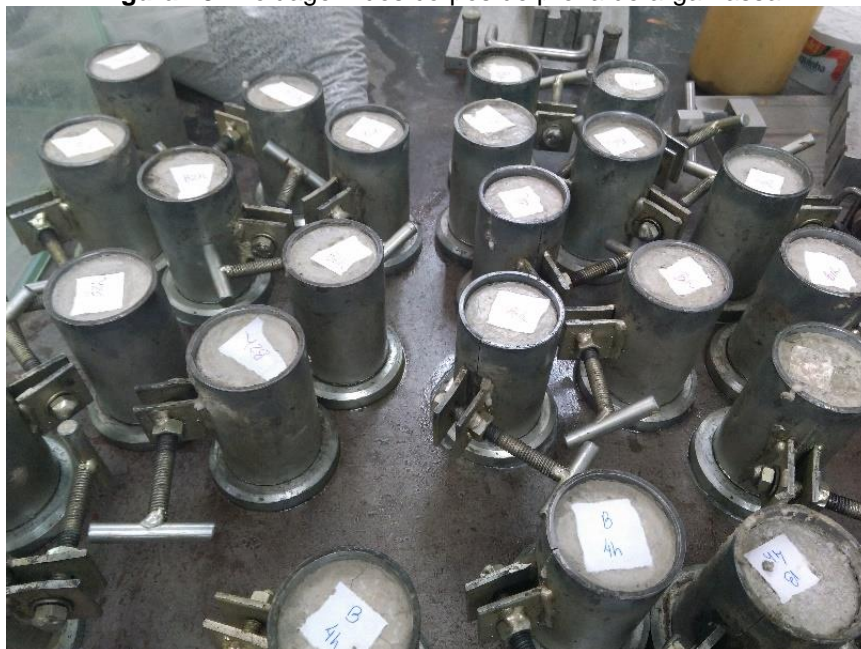
Figura 18. Moldagem dos corpos de prova de argamassa
