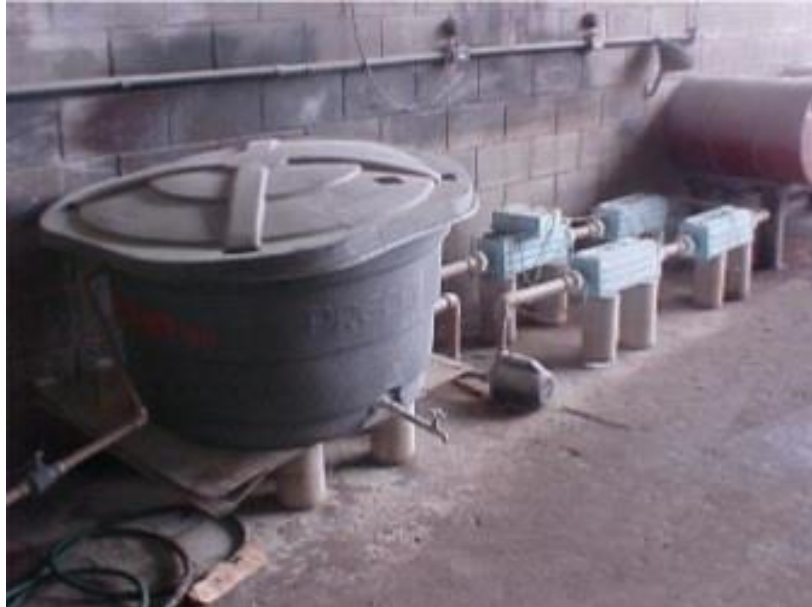
Figura 11. Equipamento de produção da água SCM em central dosadora de concreto
