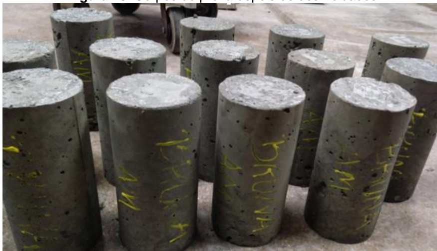
Figura 23. Corpos de prova depois de desmoldados
