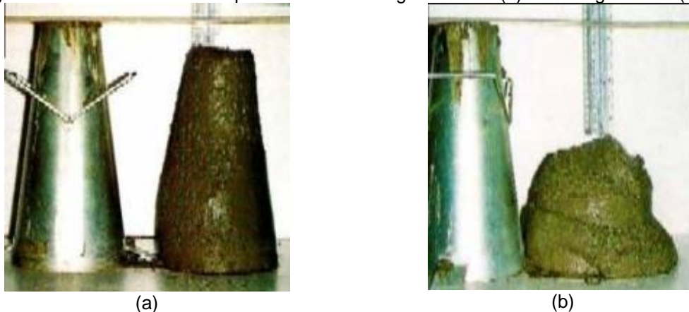
Figura 8. Teste de abatimento para mistura com água comum (a) e com água SCM (b)
