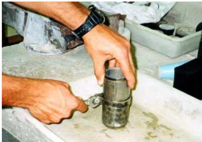
Figura 3: Moldagem dos corpos de prova com molde tripartido (FRASSON, 2000).
