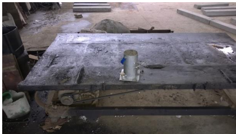
Figura 15: Compactação do corpo de prova na mesa vibratória.
